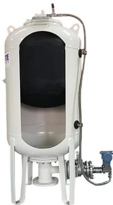
Bei Abwasserdämpfern ist im Gegensatz zu Trinkwasserdämpfern die Flüssigkeit direkt im Behälter. Eine mit Stickstoff gefüllte Blase sorgt für stabile Druckverhältnisse im System. Alternativ stehen auch Lösungen ohne Blase zur Verfügung. Hier kommen Kompressoren oder Saugventile zum Einsatz.
